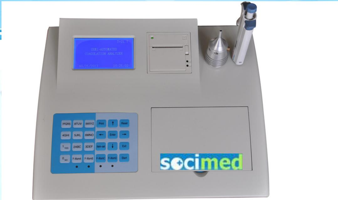
Les coagulomètres SOCIMED modèle AG02 utilisent la méthode mondialement reconnue de mesure de tests de coagulation. Le microprocesseur utilise la technologie ARM pour mesurer la vitesse de la bille magnétique afin de calculer le temps de coagulation.
